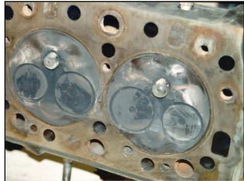
Die Glühkerze sowie die Einspritzdüse liegen in der Vorkammer und sind von der Trennfläche her nicht zu sehen! Schraubt man die E-Düse aus dem Zylinderkopf heraus, liegt der Blick in die Vorkammer frei. Deutlich sichtbar ist die Kugel des Feuersteges.
